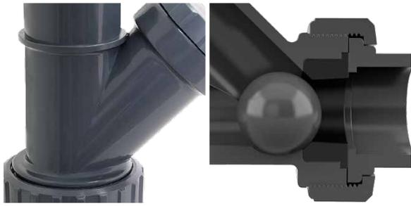
■ La Válvula antirretorno de bola “Ball” es una válvula de retención en “Y” con una bola como único elemento mecánico. Su diseño permite el paso total del fluido, obteniendo bajas pérdidas de carga y siendo apta para su uso con aguas residuales, químicas agresivas y sucias.
