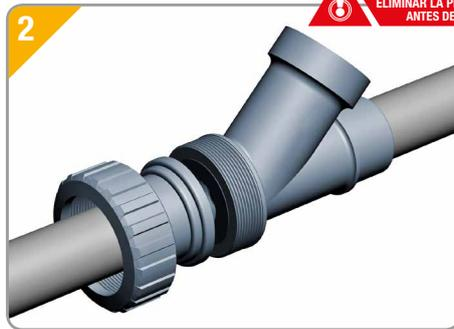
2. En caso de ser necesaria su limpieza **aflojar la tuerca** para poder desmontar la válvula.
